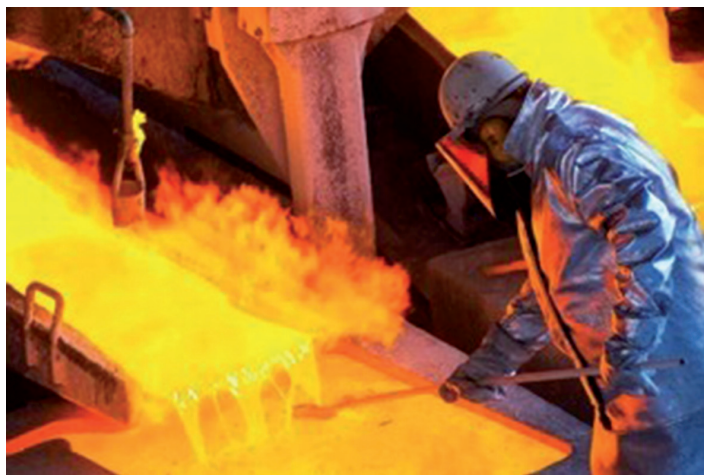
Odbijająca odzież chroniąca przed wysokimi poziomami promieniowania ciepłego, ciepła konwekcyjnego i kontaktowego (Fot. denpomo/Bigstock, Interaktywna baza wiedzy o środkach ochrony indywidualnej, CIOP-PIB, https:// soi-info.ciop.lodz.pl ).
