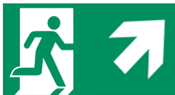
Kierunek drogi ewakuacyjnej w górę / na ukos w prawo
