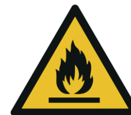
Niebezpieczeństwo pożaru – substancje łatwopalne
